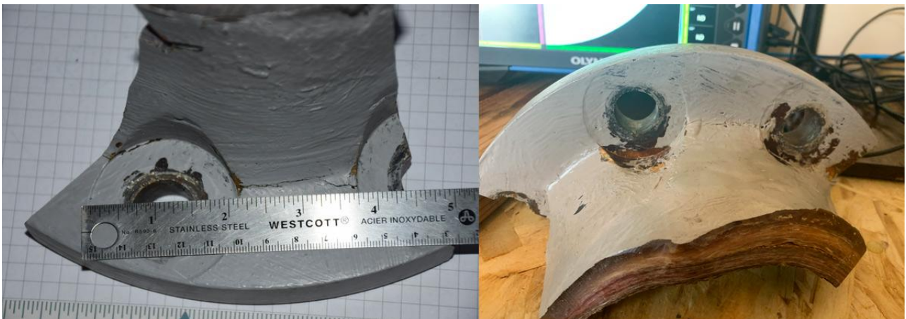
Abbildung 2: Rissbildung zwischen Schraubenlöchern eines abgetrennten GFK-Flanschprüfteils
